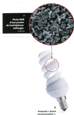
Figure 8. Projet de recyclage des luminophores à terres rares des lampes basse consommation
